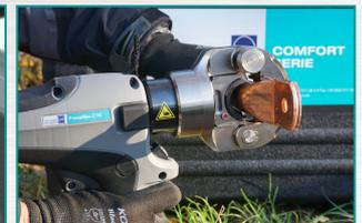
Dieses leichte, leistungsstarke Akku-hydraulische Presswerkzeug verarbeitet mit handelsüblichen C-Schalen-Presseneinsätzen Kabelschuhe und Verbinder bis 300 mm<sup>2</sup> nach DIN. In seiner Vielseitigkeit findet es Einsatz in den Bereichen EVU, Stadtwerke, der industriellen Kabelmontage oder der Windenergie.
